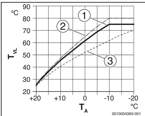
Fig. 14 Impostazione della curva termica per radiatore
