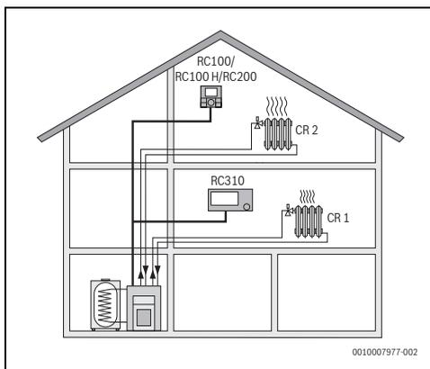
Fig. 2 RC100/RC100 H/RC200 come termoregolatore ambiente per il secondo circuito di riscaldamento (HK2) e RC310 come termoregolatore per il primo circuito di riscaldamento (HK1)
