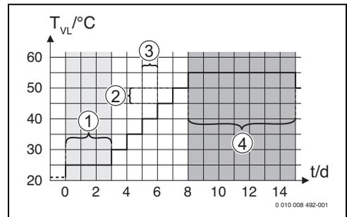
Fig. 16 Esecuzione dell'asciugatura del massetto con le impostazioni di base nella fase di riscaldamento
