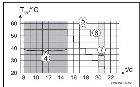
Fig. 17 Esecuzione dell'asciugatura del massetto con le impostazioni di base nella fase di raffreddamento
