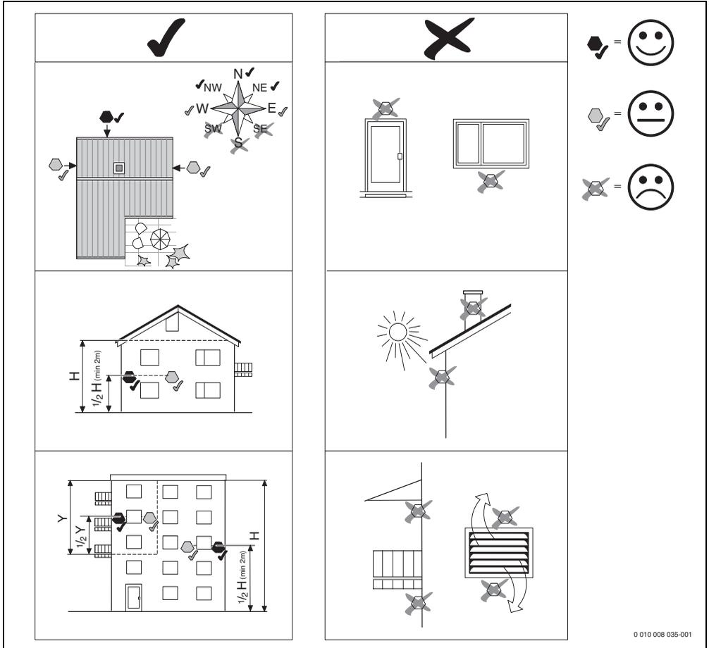
Fig. 10 Luogo di installazione della sonda di temperatura esterna (con termoregolazione in base alla temperatura esterna con o senza influsso della temperatura ambiente)
