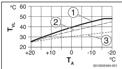
Fig. 12 Impostazione della curva termica per impianto di riscaldamento a pannelli radianti
