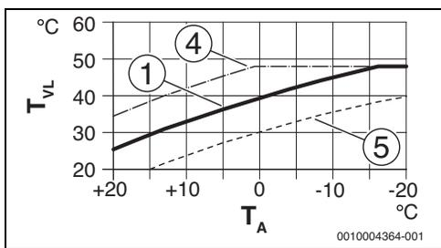
Fig. 13 Impostazione della curva termica per impianto di riscaldamento a pannelli radianti
