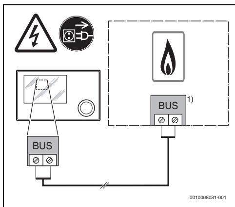
Fig. 7 Collegamento del termoregolatore al generatore di calore
