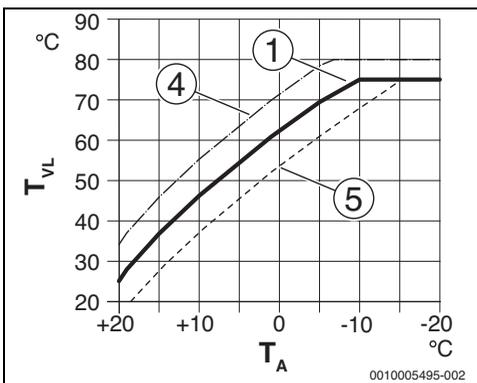
Fig. 15 Impostazione della curva termica per radiatore
