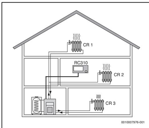
Fig. 1 RC310 come termoregolatore per più (in questo caso tre) circuiti di riscaldamento
